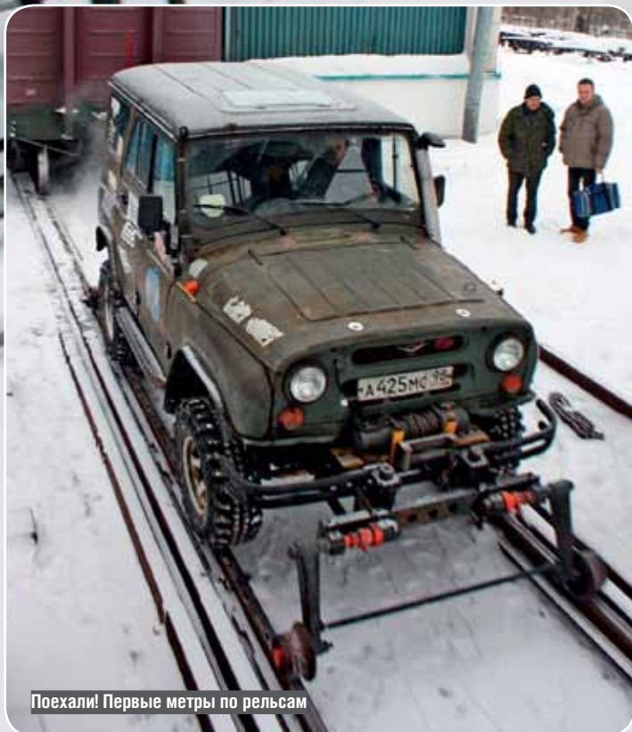
Проверка тяговых свойств: чтобы тянуть порожний вагон весом в 26 тонн, нужно приложить усилие порядка полутора тонн
